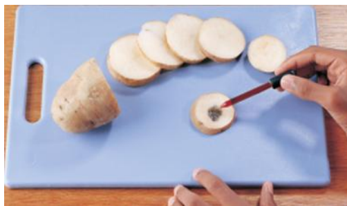
شکل ۲ ب. ید با نشاسته دچار یک تغییر شیمیایی می‌شود و رنگ آن تغییر می‌کند.
