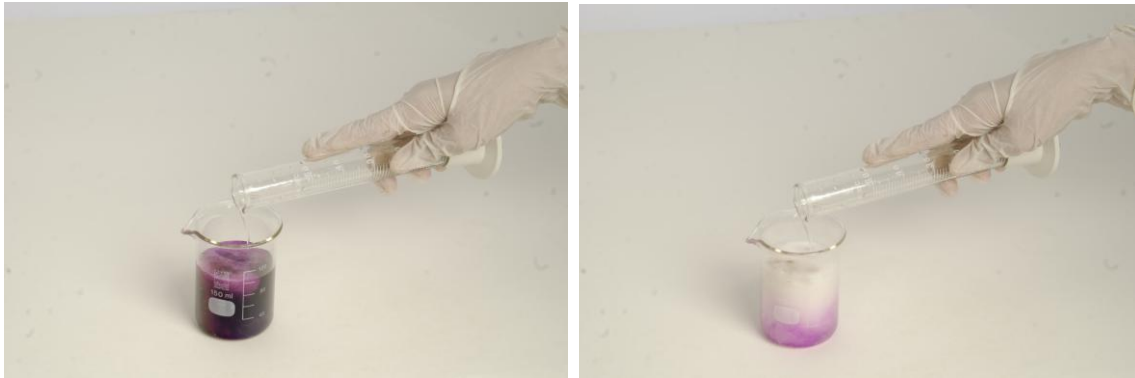
شکل ۲. آب اکسیژنه با پتاسیم پرمنگنات دچار تغییر شیمیایی می‌شوند و رنگ پرمنگنات از بین می‌رود.
