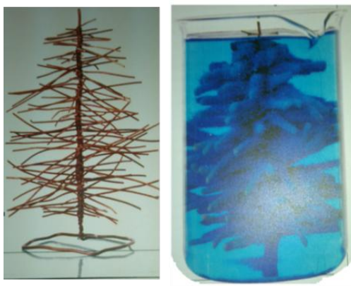
شکل ۲ آ. با قرار دادن سیم مسی (درختچه مسی) در محلول نقره نترات رنگ محلول تغییر می‌کند.
