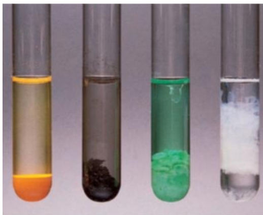
شکل ۱ تشکیل رسوب های آلومینیم هیدروکسید، نیکل هیدروکسید، سرب سولفید، کادمیم سولفید
